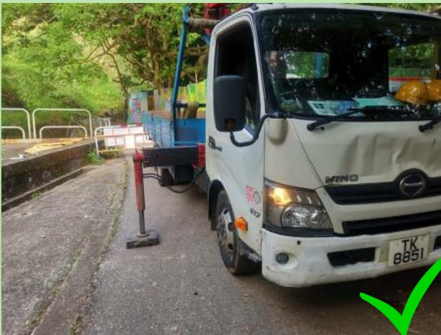
支重腳撐已完全伸展及使用橡膠墊板
