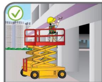
使用合適的工作平台，例如：動力操作升降工作台或流動工作台
